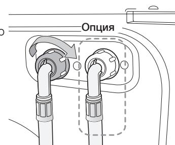
6. Включите подачу воды и убедитесь, что нет протечки воды из клапана подачи воды, крана или адаптера. Если есть протечка воды, повторите предыдущие действия.
