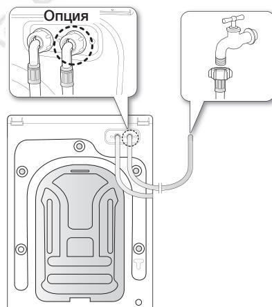
2. Подсоедините другой конец шланга подачи холодной воды к водопроводному крану с холодной водой и затяните соединение вручную. Если необходимо, можно изменить положение шланга подачи воды на стиральной машине. Для этого ослабьте соединение, поверните шланг и снова затяните соединение.
